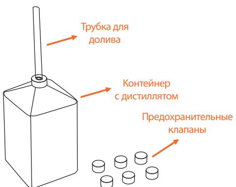
Шаг 4: Мягко выдавите дистиллят из контейнера полностью. Закройте предохранительный клапан крышкой, когда наполнение будет закончено.
